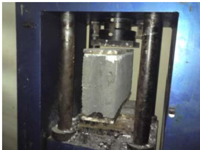
Gambar Uji Tekan Bata Beton Pejal
