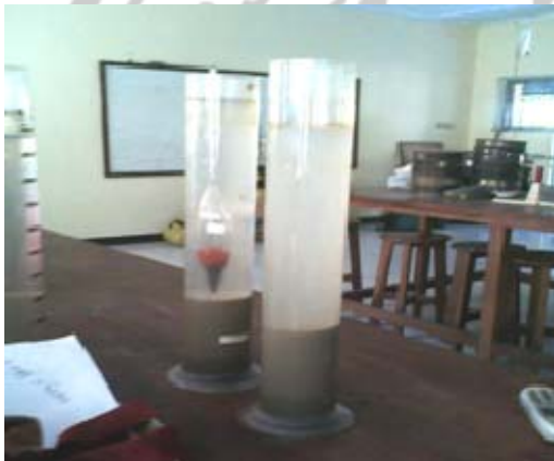
Uji Distribusi Tanah
