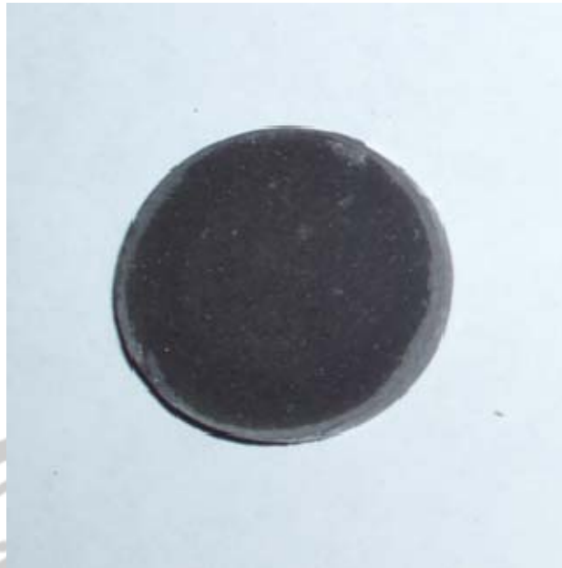
Gambar Kaca Magnetik dengan komposisi barium ferit 1,25%
