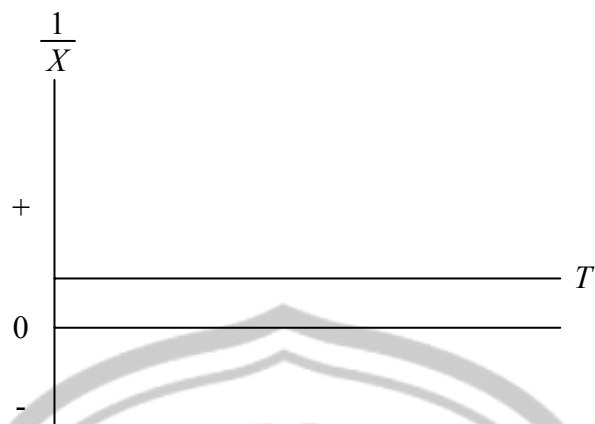
Gambar 2.5 Kurva hubungan temperatur dengan susceptibility untuk material diamagnetik.
