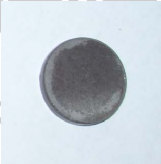
Gambar Kaca Magnetik dengan komposisi barium ferit 1,5%
