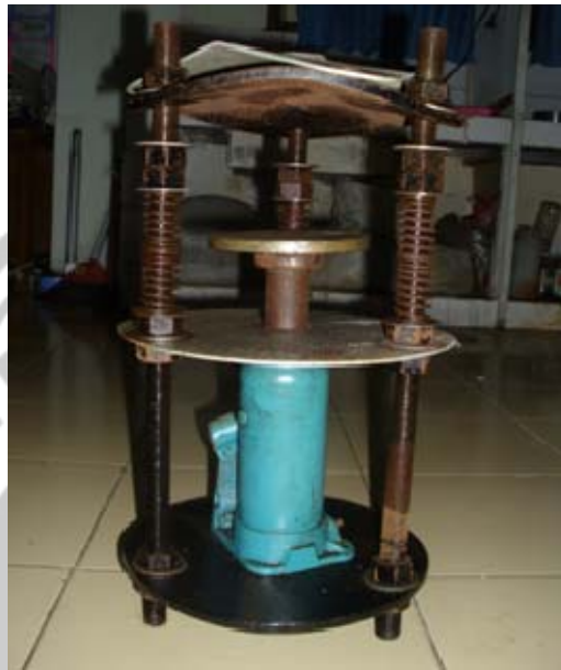
Gambar hydraulic press cap 16 ton Ram Dia 100 mm
