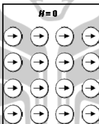
Gambar 2.4 Susunan momen dipol untuk material feromagnetik tanpa ataupun dengan adanya medan magnet dari luar.
