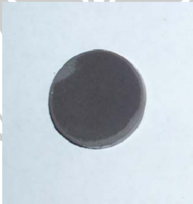
Gambar Kaca Magnetik dengan komposisi barium ferit 0,5%
