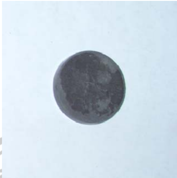
Gambar Kaca Magnetik dengan komposisi barium ferit 0,75%
