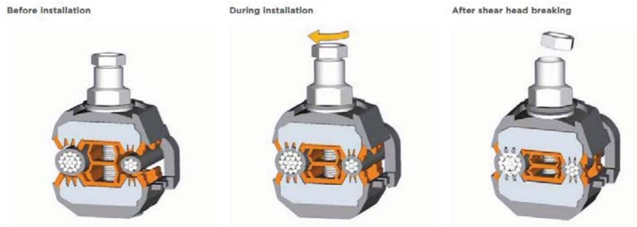
Gambar 2.15 Pemasangan Tap Connector
