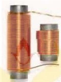
Gambar 2.24. Induktor (teknikelektronika.com)
