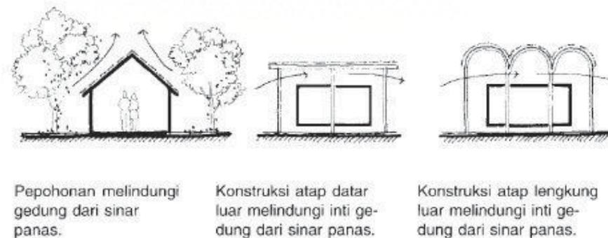
Gambar 2.37 Skema konstruksi atap yang melindungi bangunan dari sinar panas
