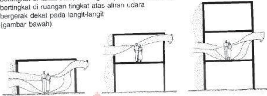
Gambar 2.33 Skema aliran udara pada bangunan bertingkat
