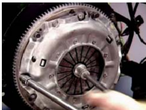
Gambar 42. Pengencangan baut clutch cover
