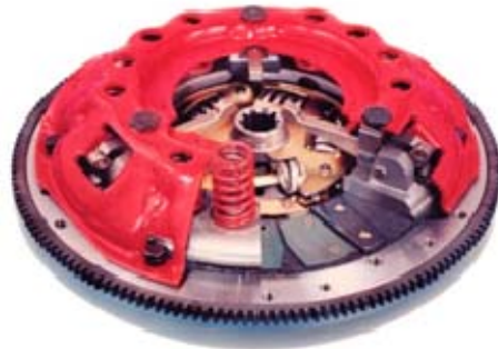
Gambar 2. Kopling gesek dengan pegas coil
