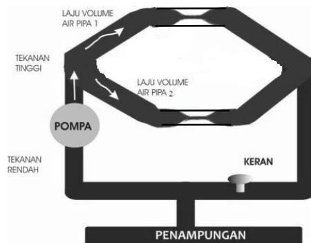
Gambar 2.6 Rangkaian analog dengan dua bagian pipa yang menyempit dan letaknya paralel
