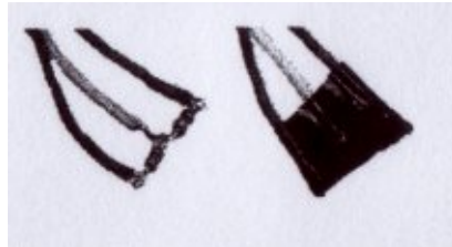
Gambar 3.9: Menyolder dan membentuk kedua resistormenjadi satu
