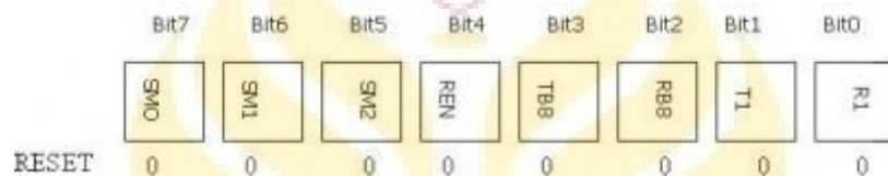
Gambar 5.1: Susunan Bit dalam SCON
