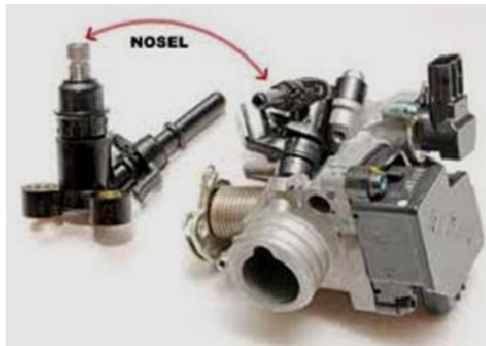
Gambar 2.10 penempatan injector pada throttle body
