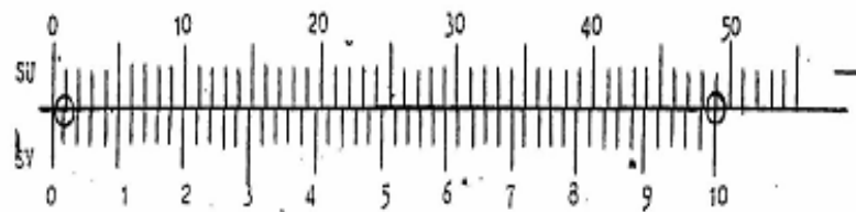
Gambar 5. Mistar geser dengan ketelitian 0,02 mm
