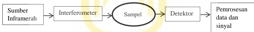
Gambar II.2 Gambar Komponen Dasar Instrumen FT-IR
