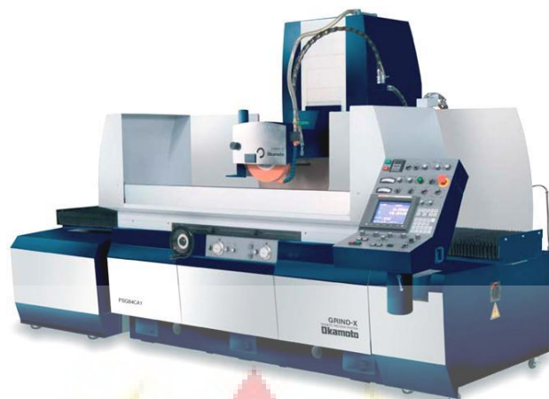
Gambar 2.11. Mesin gerinda datar CNC (Mursidi dan Tatang, 2013: 22)
