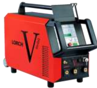
Gambar 3. Mesin Las LORCH V 30 (DIN EN 60974-1) 3-300 A.
