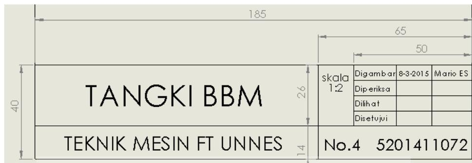
Gambar 2.16. Etiket gambar standar model VSM (sekolah teknik)
