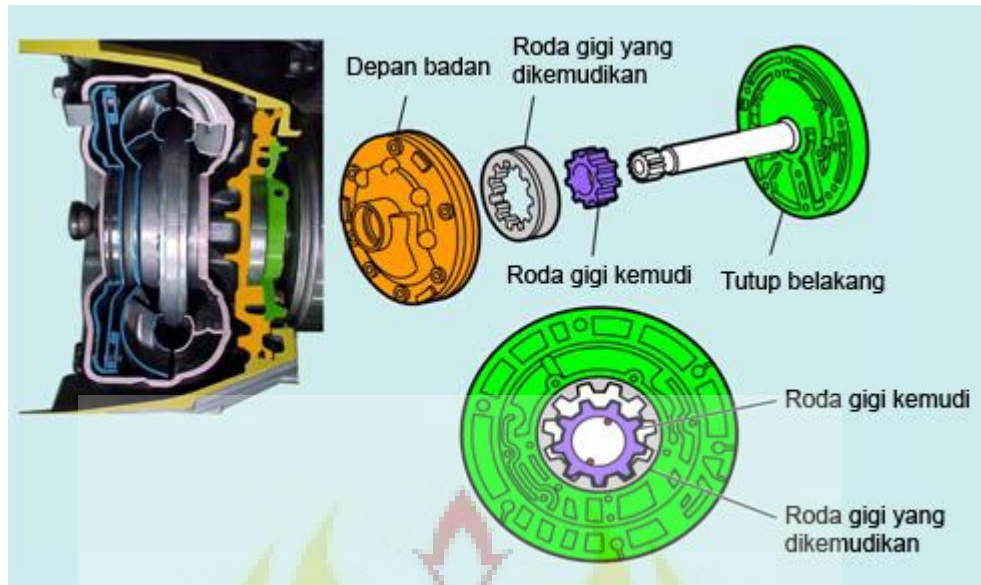
Gambar 2.24 Pompa Oli BPM Kemdikbud (2008)
