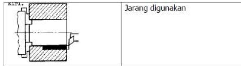
Gambar 14. Siklus pembubutan G84 yang jarang digunakan
