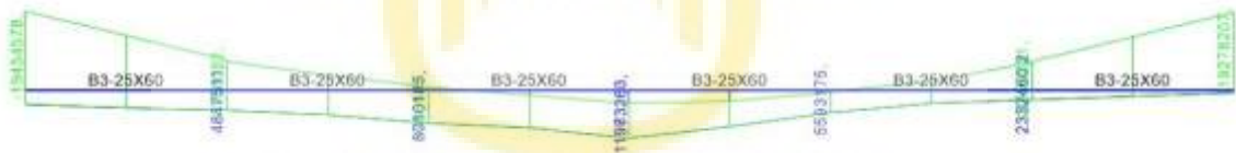
Gambar 4.12 Momen yang terjadi pada Balok B3-25x60
