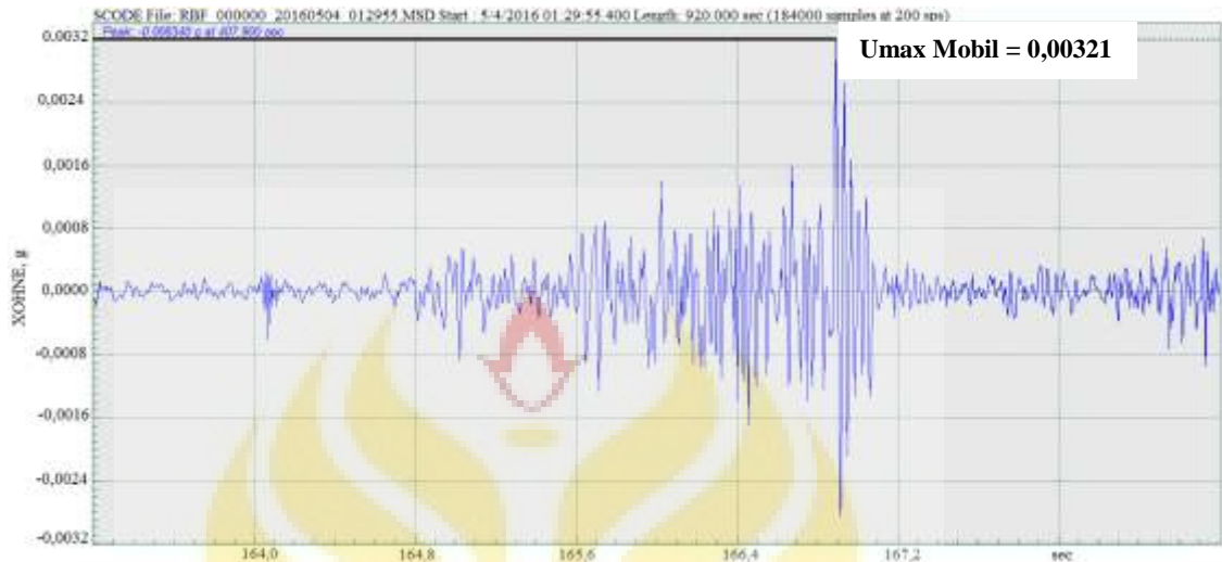
Gambar 5.2. Detail 2, Grafik Getaran Kendaraan Mobil
