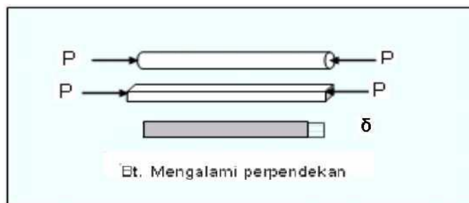
Gambar 2.2. Tegangan normal tekan pada batang prismatik
