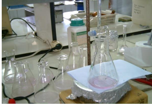
Gambar 5.5. Hasil titrasi pada uji aktivitas lipase
