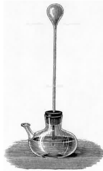
Gambar 2.4 Model gagasan awal Galileo untuk termometer
