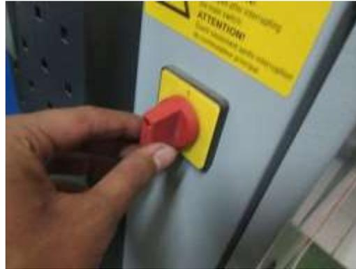
Gambar 3.6 Menghidupkan dinamometer.
