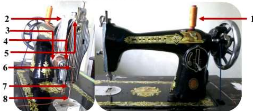
Gambar 1.10 Langkah-langkah Memasang Benang (Sumber: Dokumentasi Sarah)
