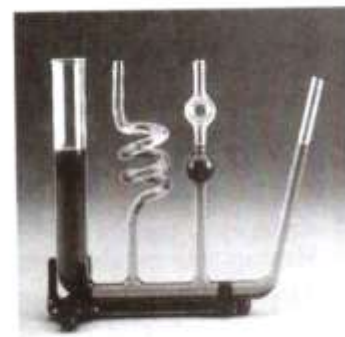
Gambar 7.61 Permukaan zat cair sejenis dalam suatu bejana berhubungan.
