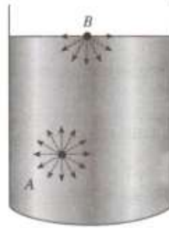
Gambar 7.43 Partikel A dalam zat cair ditarik oleh gaya sama besar ke segala arah oleh partikel-partikel di dekatnya. Partikel B di permukaan zat cair hanya ditarik oleh partikel-partikel di samping dan di bawahnya, hingga pada permukaan zat cair terjadi tarikan ke bawah.
