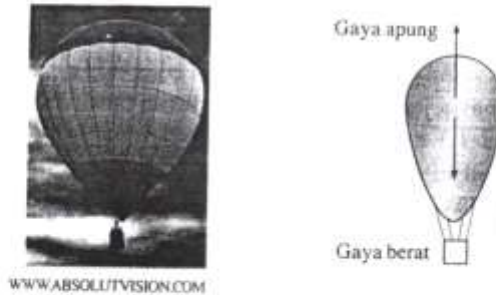
Gambar 7.39 Balon udara naik ke atas berdasarkan prinsip gaya apung yang dikerjakan udara.
