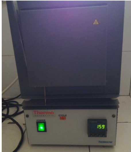
Minyak dipanaskan dalam Furnace T 300 2 jam
