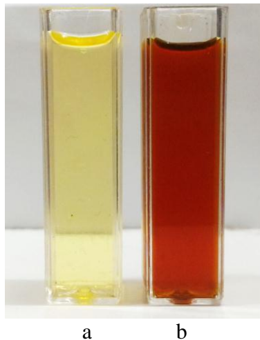
Gambar 4.1. (a) Minyak goreng sebelum pemanasan dan (b) Minyak goreng setelah pemanasan.
