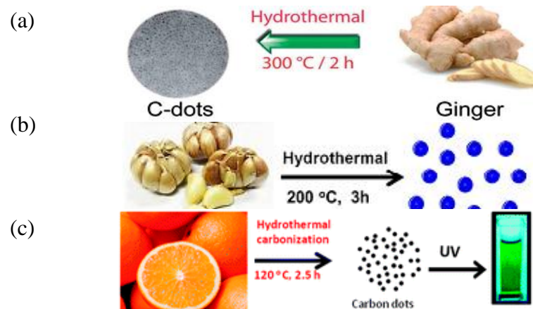
Gambar 2.4. Ilustrasi pembuatan C-Dots dari (a) jahe, (b) bawang putih, dan (c) sari jeruk (Li et al. , 2014; Zhao et al. , 2015; Sahu et al. , 2012).
