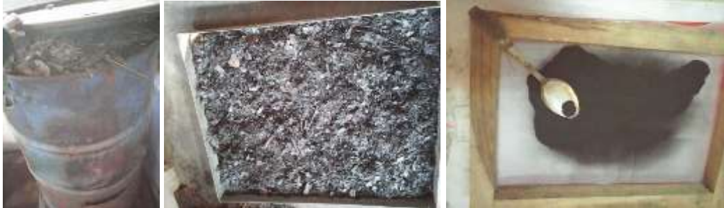
Gambar 5.1 Proses pirolisis limbah daun dan menghomogenkan serbuk karbon.
