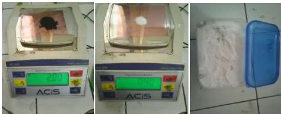
Gambar 5.2 Persiapan fabrikasi LECA dengan menimbang bahan-bahan yang diperlukan.
