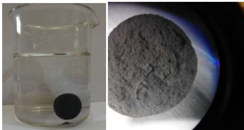
Gambar 5.4 (a) LECA direndam dalam aquades , (b) karakterisasi LECA dengan Mikroskop optik.
