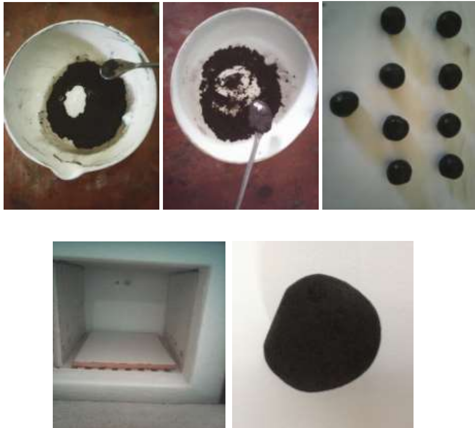
Gambar 5.3 (a) Serbuk karbon, PEG, aquades , dan PVAc dicampur dalam cawan, (b) diaduk, (c) LECA yang berhasil difabrikasi, (d) furnace untuk memanaskan LECA, dan (e) LECA yang telah dipanaskan.
