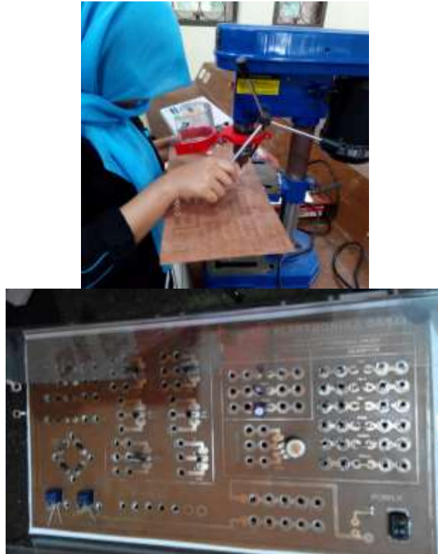
Gambar 4.3 Pengeboran dan Pemasangan Komponen
