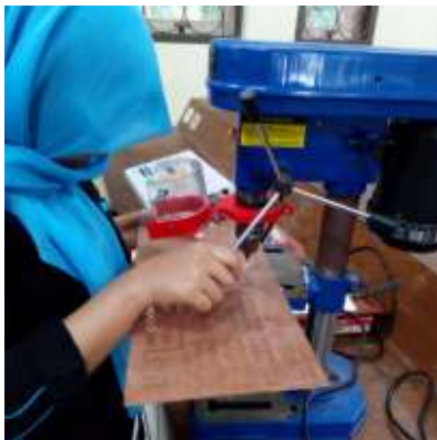
Gambar Lampiran 3.2 Pengeboran dan Pemasangan Komponen
