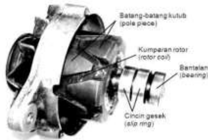
Gambar 4.17 Komponen bagian dalam alternator
