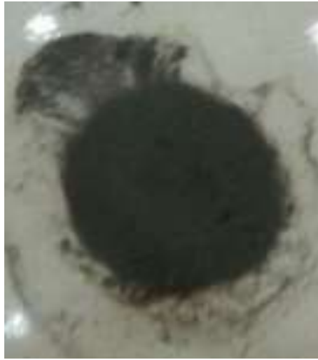
Gambar 7. Endapan Nanopartikel sesudah di Oven
