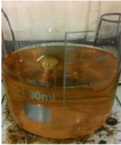
Gambar 3. Pencampuran ekstrak Cengkeh dengan \text{CuNO}_3
