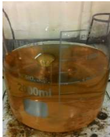
Gambar 4.3 Larutan ekstrak bunga cengkeh setelah dicampur dengan larutan \text{CuNO}_3 0,01 N
