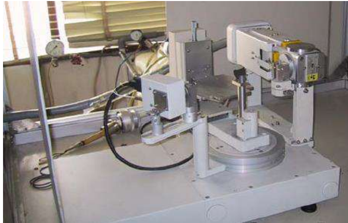
Gambar 3.7. XRD merk Philips tipe PW/1835
