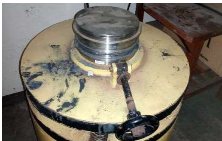
Gambar 3.3. Mesin milling jenis Vibratory ball Milling (Laboratorium Universitas Negeri Semarang)
