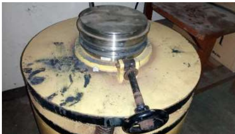
Gambar 3.3. Mesin milling jenis vibratory ball milling (Laboratorium Universitas Negeri Semarang).
