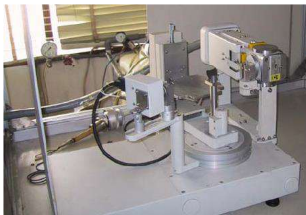
Gambar 3.7. XRD merk Philips tipe PW/1835.
