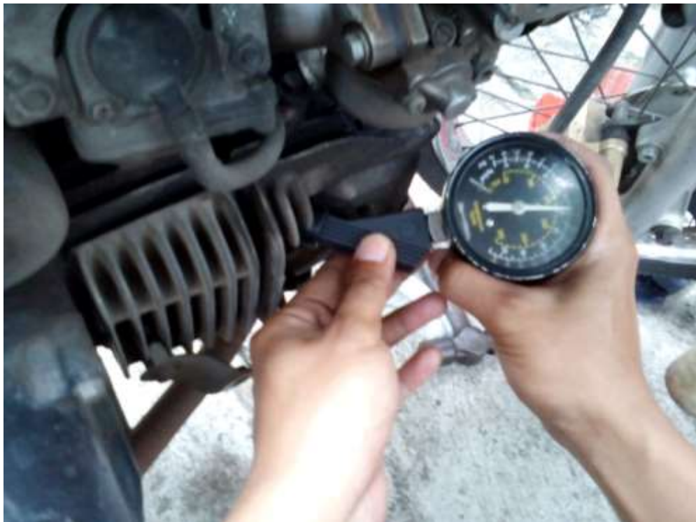
Gambar 4. Pengukuran tekanan kompresi.
