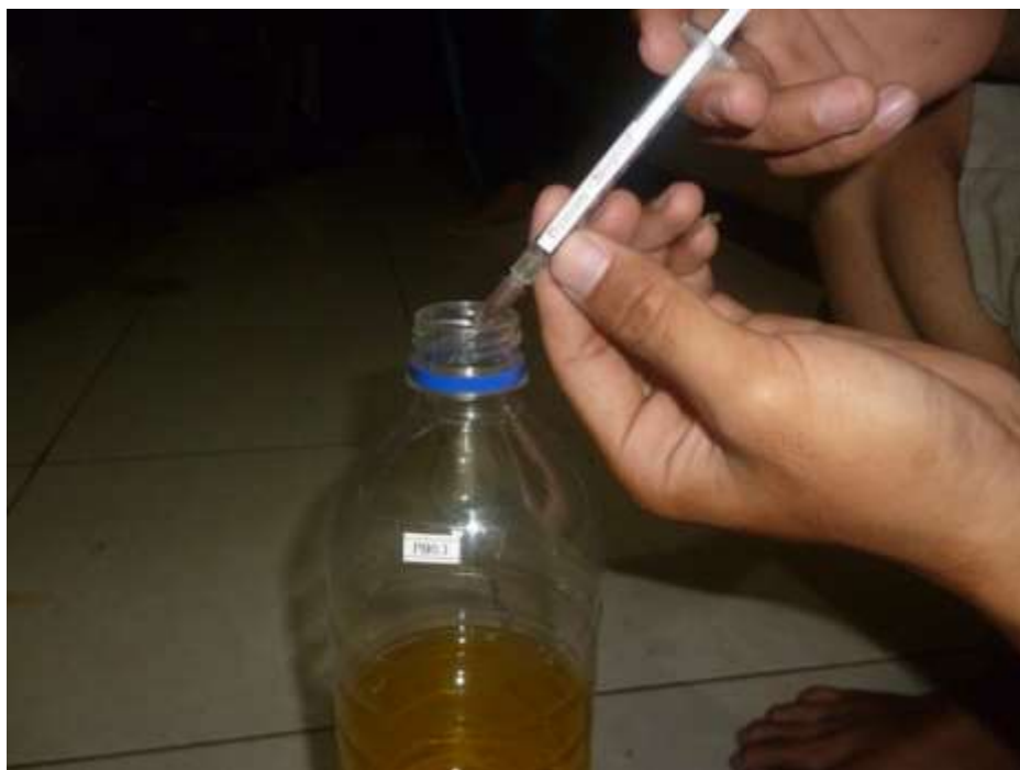
Gambar 2. Proses pencampuran zat aditif Biospeed ke dalam Premium
