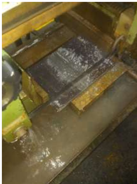
Gambar 4.0. Proses pemotongan untuk membuat spesimen
