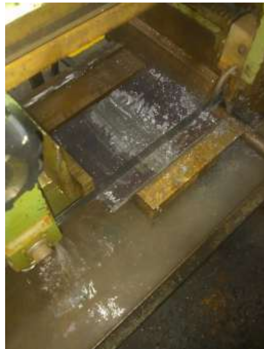
Proses Awal Pengelasan Titik dan Proses Pemotongan Spesimen Uji Tarik
