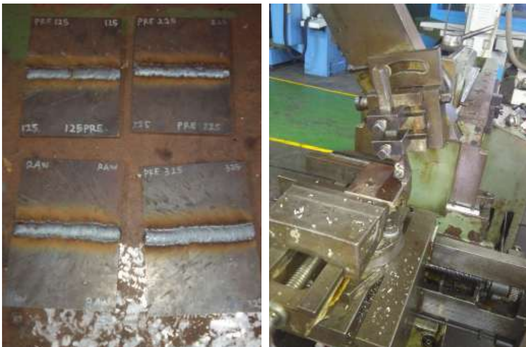
Hasil proses pengelasan GMAW dan Proses Pembuatan Kampuh sudut 30°
