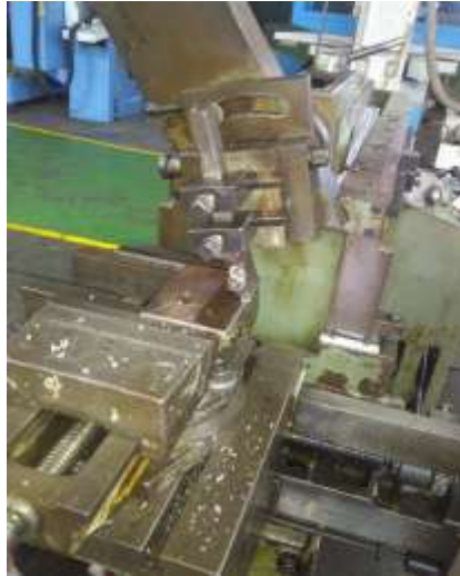
Gambar 3.5. Proses pembuatan kampuh
