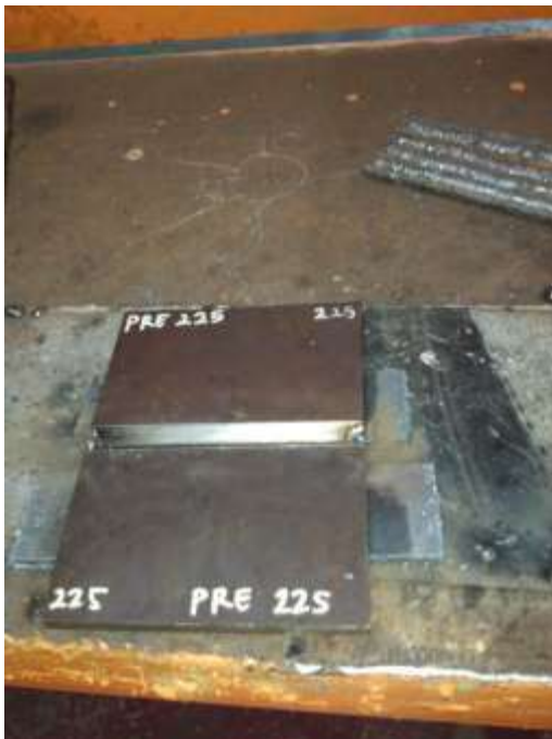
Proses Awal Pengelasan Titik dan Proses Pemotongan Spesimen Uji Tarik
