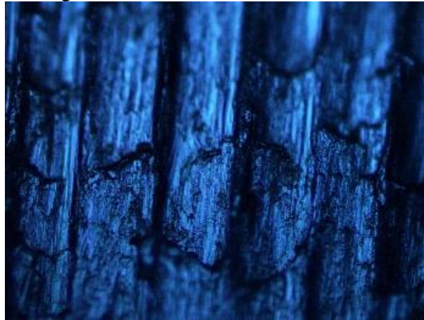
Gambar 4.11. Hasil foto makro spesimen dengan sudut geram 16^\circ dan sudut bebas sisi 8^\circ
