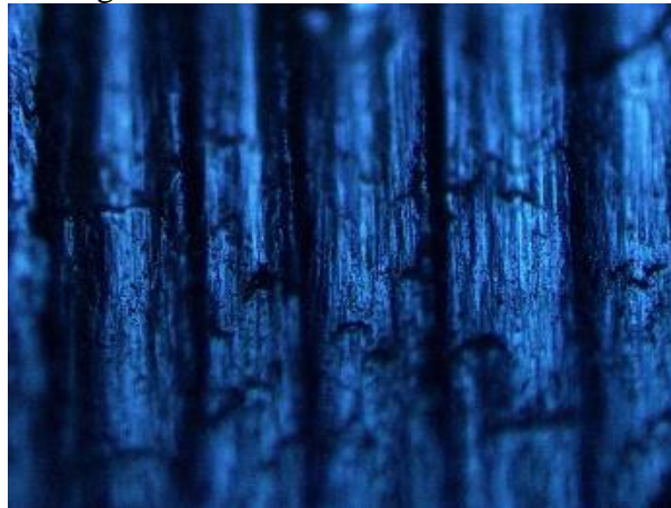
Gambar 4.14. Hasil foto makro spesimen dengan sudut geram 20^\circ dan sudut bebas sisi 8^\circ
