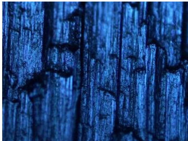
Gambar 4.8. Hasil foto makro spesimen dengan sudut geram 14^\circ dan sudut bebas sisi 8^\circ
