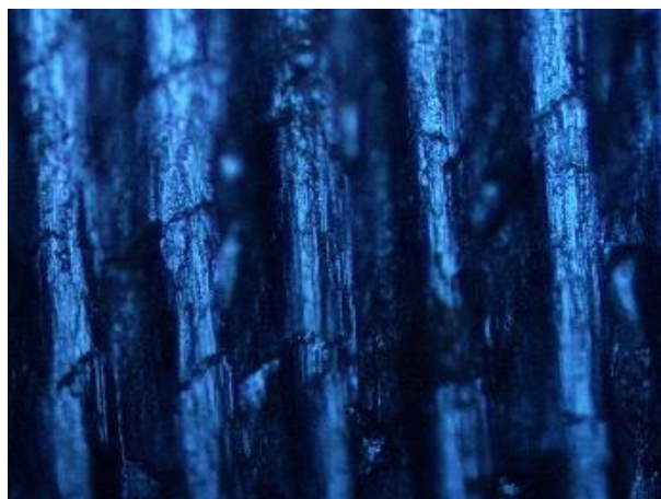
Gambar 4.15. Hasil foto makro spesimen dengan sudut geram 20^\circ dan sudut bebas sisi 9^\circ
