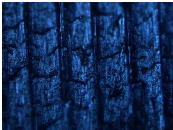
Gambar 4.6. Hasil foto makro spesimen dengan sudut geram 12^\circ dan sudut bebas sisi 9^\circ
