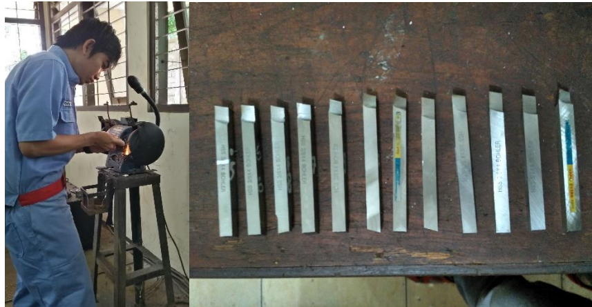
Gambar 3.5. Proses pengasahan pahat dan spesimen pahat (Dokumentasi Pribadi)
