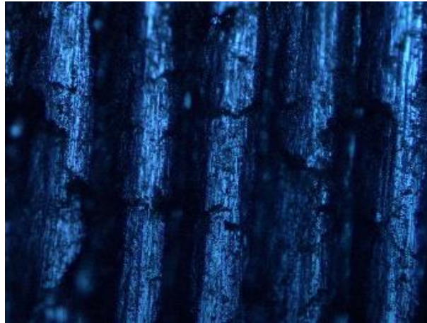
Gambar 4.13. Hasil foto makro spesimen dengan sudut geram 16^\circ dan sudut bebas sisi 10^\circ
