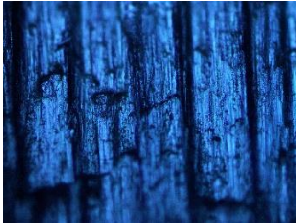
Gambar 4.10. Hasil foto makro spesimen dengan sudut geram 14^\circ dan sudut bebas sisi 10^\circ
