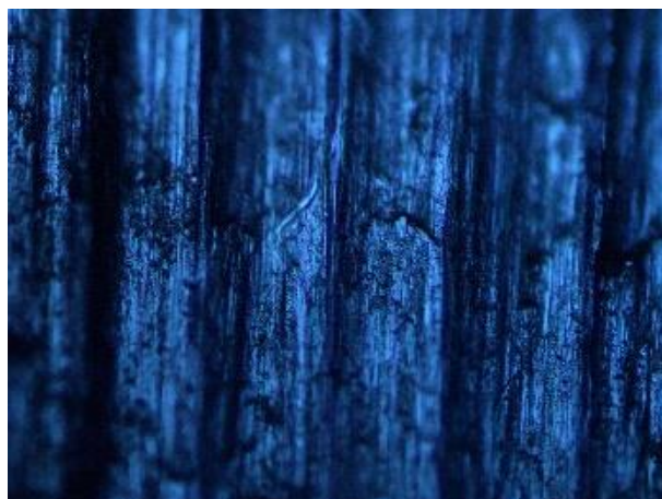
Gambar 4.9. Hasil foto makro spesimen dengan sudut geram 14^\circ dan sudut bebas sisi 9^\circ
