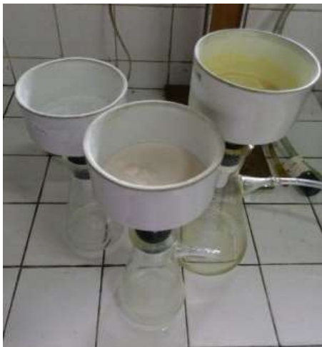
Proses filtrasi katalis sampai bebas ion Cl
