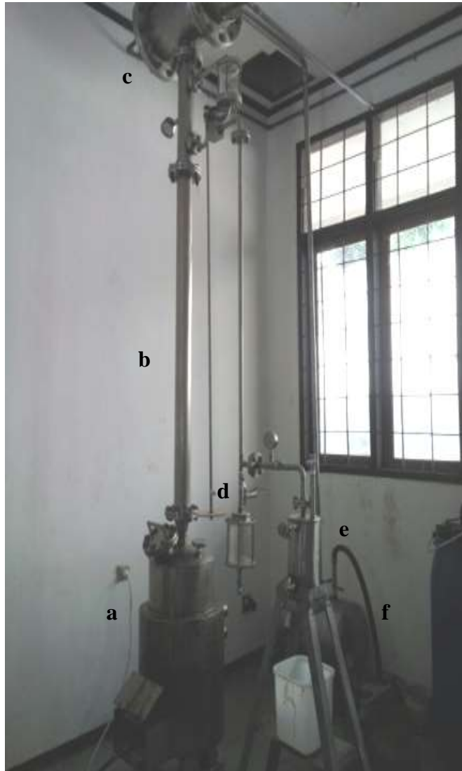
Gambar 4.2. Rangkaian Alat Destilasi Pengurangan Tekanan Teknologi Industri Pertanian UNPAD
