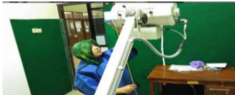
Mengukur ketinggian tabung sinar-x
