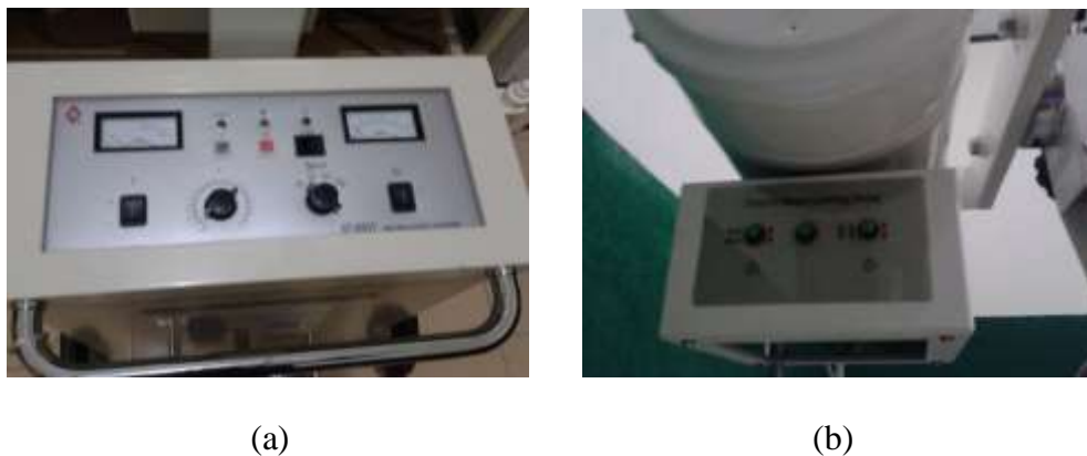
Gambar 3.2 Bagian dari pesawat sinar x, (a) Kontrol panel, (b) Tabung pesawat sinar-x
