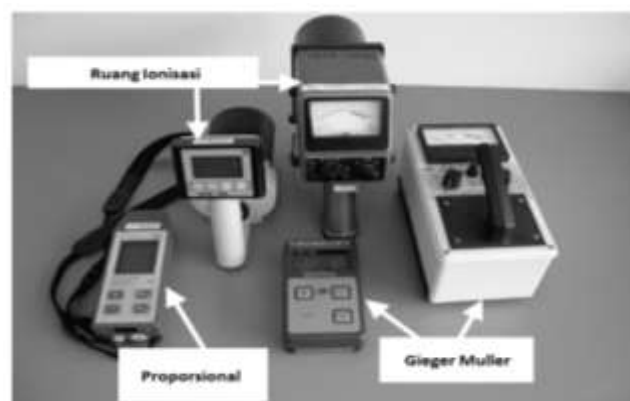
Gambar 2.2 Surveymeter detektor isian gas proporsional, ruang ionisasi dan Geiger Muller (Podgorsak, 2005: 104)
