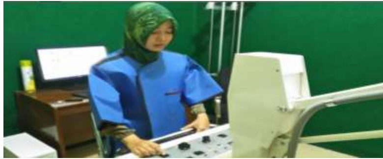
Pengaturan Faktor eksposi pada pesawat sinar x.
