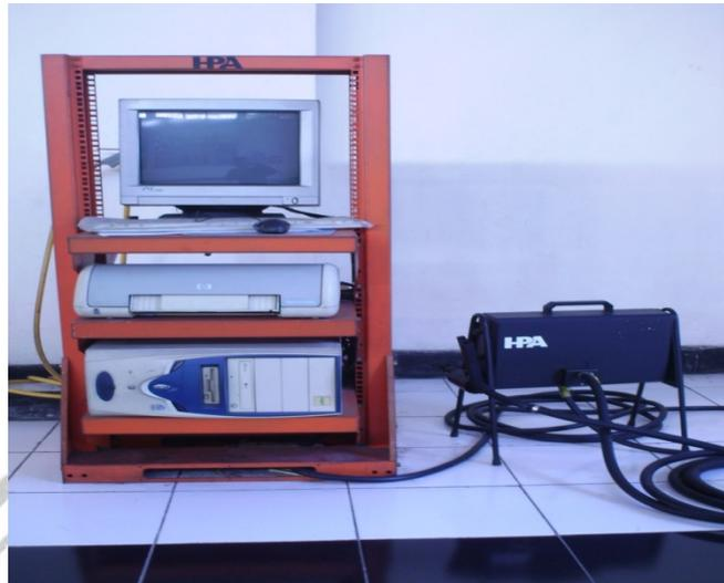
Fungsi : Smoke Tester adalah suatu alat uji yang digunakan untuk mengetahui atau mendeteksi tingkat ketebalan asap gas buang kendaraan bermotor dengan bahan bakar solar.
