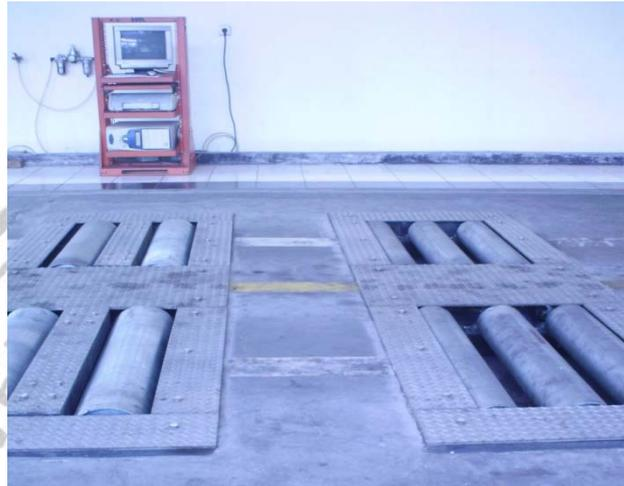
Fungsi: mengetahui besarnya penyimpangan alat ukur kecepatan kendaraan bermotor yang di ukur pada kecepatan kendaraan 40 km/jam.
