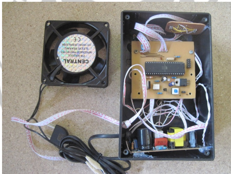
Gambar 15. Rangkaian Otomatisasi Sensor Suhu Dengan Kipas Angin
