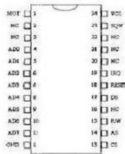
Gambar 14. Konfigurasi pin RTC DS12887
