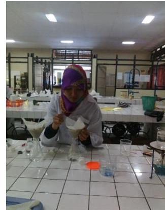
Proses penyaringan setelah pencucian bentonit
