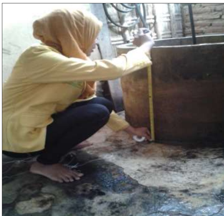
Gambar 4: Pengukuran Tinggi Bibir Sumur dengan Menggunakan Roll
