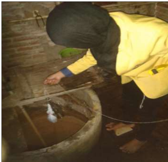
Gambar 6: Pengambilan Air Sumur Gali Menggunakan Botol Gelas dengan Pemberat
