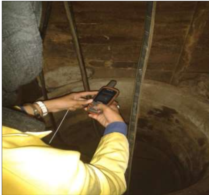
Gambar 5: Mengambil titik koordinat Sumur Gali untuk Pengukuran Jarak ke Sumber Pencemar
