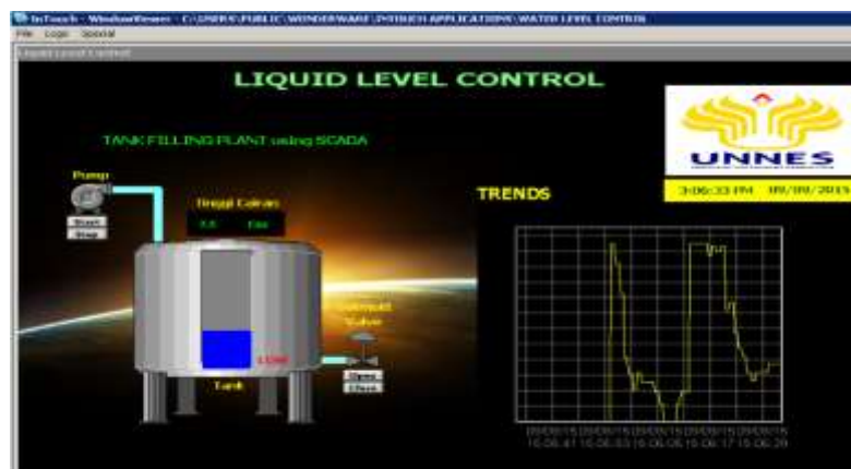
Gambar 4.10 Kondisi cairan dalam tangki saat low level
