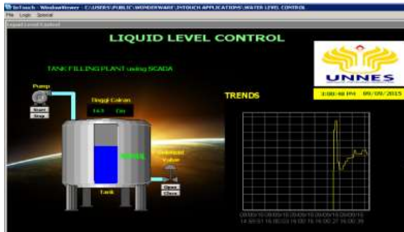
Gambar 4.11 Kondisi cairan dalam tangki saat normal
