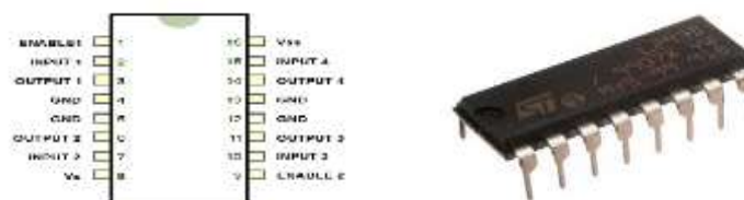
Gambar 2.14 Konstruksi Pin dan bentuk fisik IC L293D
