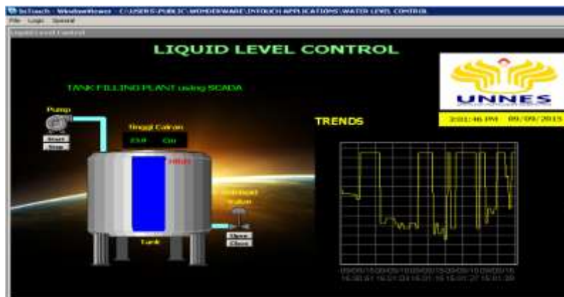
Gambar 4.12 Kondisi cairan dalam tangki saat high level
