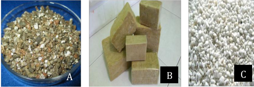
Gambar 7. Berbagai macam bahan substrat medium kultur fotoautotrofik. A. Vermikulit, B. Rockwool , C. Perlite
