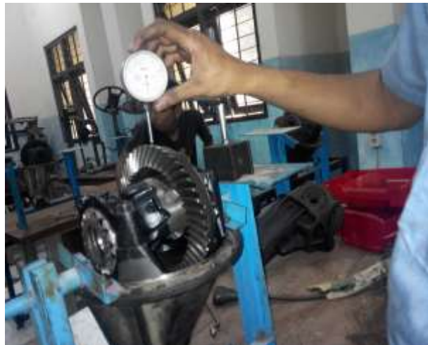
Gambar 3.19 Menyetel Backlash Ring Gear dengan Dial Indicator
