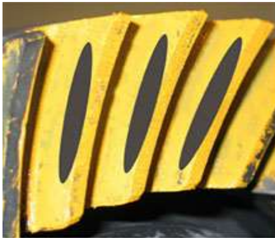
Gambar 3.16 Hubungan gesekan yang terjadi pada ujung gigi ring gear
