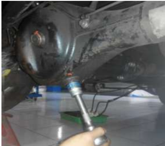
Gambar 3.1 Menguras Oli Pelumas Differential
