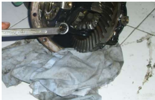
Gambar 3.8 Melepas Bearing Cap dan Mur Penyetel
