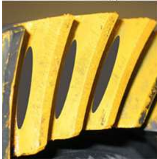
Gambar 3.17 Hubungan gesekan yang terjadi pada alas gigi ring gear
