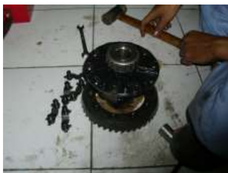
Gambar 5. Melepas Ring Gear
