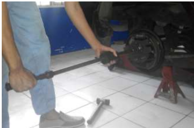
Gambar 3.2 Melepas Poros Axel Menggunakan Palu Luncur
