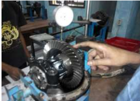
Gambar 3.4 Memeriksa Backlash Ring Gear dengan Drive Pinion
