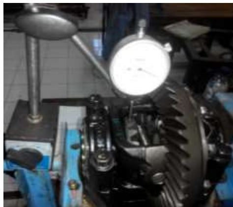
Gambar 3.6 Memeriksa Backlash pada Side Gear
