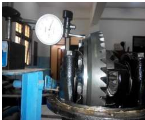
Gambar 3.5 Memeriksa Run Out Ring Gear dengan Dial Indicator
