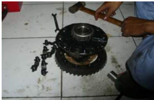
Gambar 3.10 Melepas Ring Gear dari Differential Carrier
