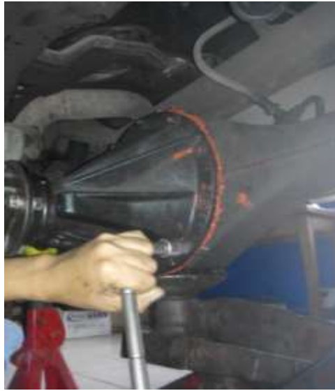
Gambar 3.3 Melepas Differential dari Kendaraan
