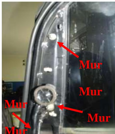
Gambar 3.4 Memasang mur dan konektor
