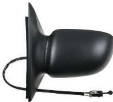
Gambar 2.2 *Manual Remote Mirrors* (Nutt, 2015)
