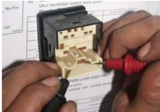
Gambar 3.5 Langkah pengukuran hambatan
