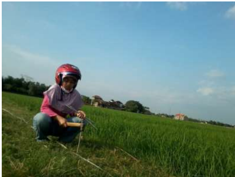
Memasang elektroda dengan menginjeksikan elektroda ke dalam tanah dengan menggunakan palu
