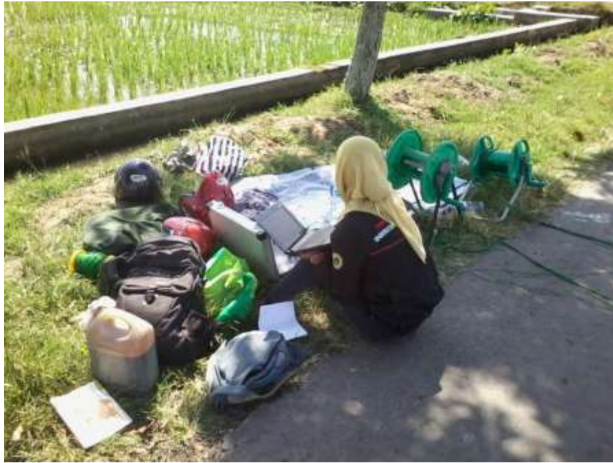
Pengambilan data dengan menggunakan satu set alat geolistrik
