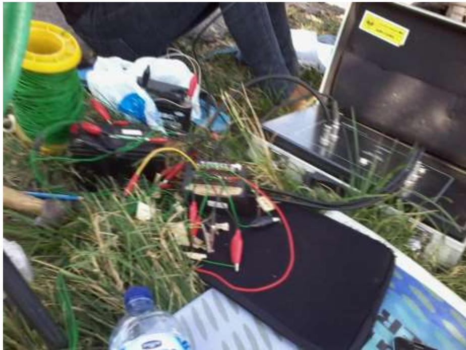
Penyambungan kabel dan memastikan kabel yang digunakan terhubung semua
