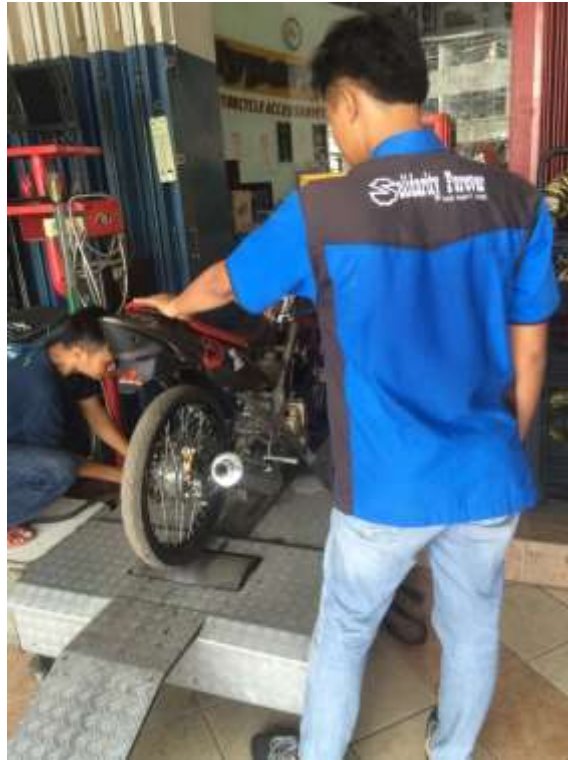
Gambar 3. Instalasi sepeda motor pada dynamometer
