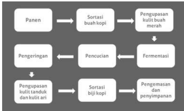
Gambar 2.23. Tahapan Pengolahan Biji Kopi dengan Proses Basah
